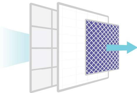
プレフィルター・HEPAフィルター、そして光触媒の3層フィルターで空気中の有害物質を99%以上除去します
